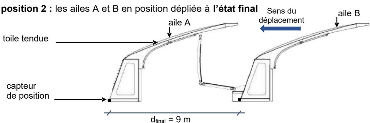
En se déployant, l'aile A passe de la position 1 à la position 2.
