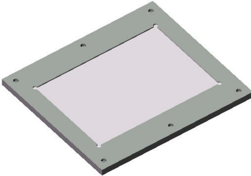
Plateau martyr surfacé avec perçage pour le capteur d'outil
