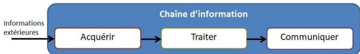
**Acquérir** : c'est le travail des **capteurs** qui vont détecter les conditions du système et les transmettre
