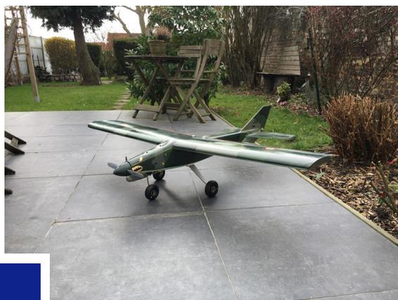
Avion de transition équipé d'un moteur thermique 2 temps permettant la familiarisation du jeune pilote avec un avion plus rapide et exigeant au niveau du pilotage.
