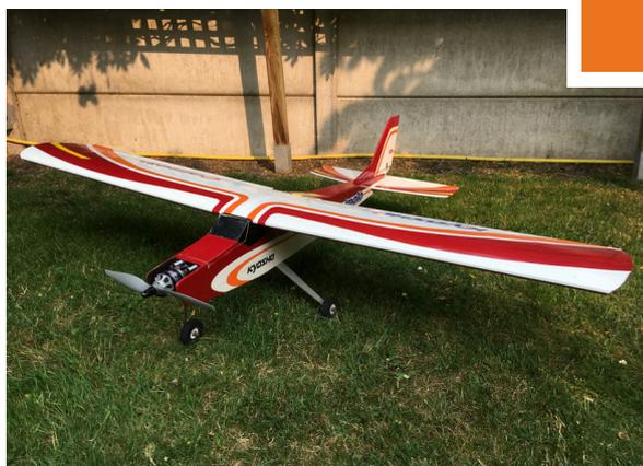
Avion école du club AMC Blériot de Cambrai équipé d'un moteur électrique permettant l'étude d'une chaîne de propulsion électrique et l'apprentissage du pilotage
