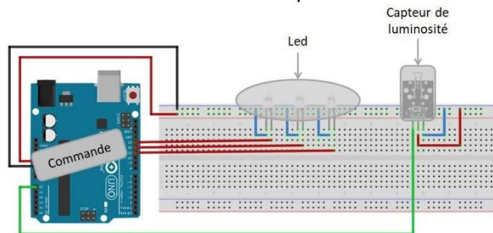
Le capteur de luminosité mesure la luminosité ambiante et la transmet à la commande qui, quand il ne pas suffisamment clair, envoie de l'électricité aux LED qui s'allument.
