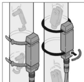
Détection de pièces dans un tube
