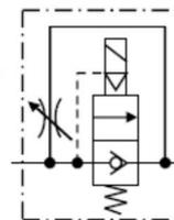
Cette électrovanne doit être maintenue sous tension dans les conditions normales d'utilisation. Toute mise hors tension de ce pilote place le démarreur en position "faible débit".
